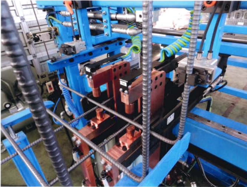
▲ エアハンドクランプ位置固定スターラップ溶接風景
